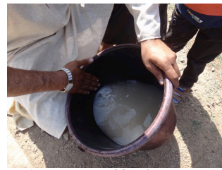
3. 水に500gの明礬を溶かし、半量ずつに分け、一方にのみ鉄媒染液を適量混ぜておく。
